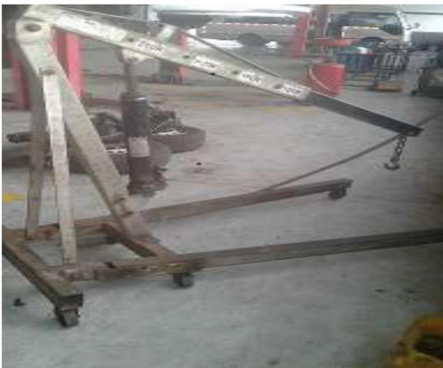
GRUA ELEVA MOTORES TIENE UNA CAPACIDAD DE 2 TONELADAS.
